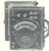
Wattmetro elettrodinamico portatile di precisione Weston
